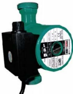
модели UPS 25-40, UPS 25-60, UPS 25-80, UPS 32-40, UPS 32-60, UPS 32-80 (**H0201–H0206**) предназначены для работы в системах отопления, охлаждения или кондиционирования. Частота вращения устанавливается с помощью простого переключателя, что позволяет легко корректировать температуру обогрева. Обмотки двигателя устойчивы к току блокировки, поэтому им не требуется дополнительная защита, более мощные оборудованы термовыключателями, встроенными в клеммную коробку.
