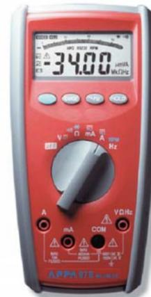
тил внимание, что погрешность АППА-97 (И4929) — 0,3%, он прямоугольный, ударопрочный, влагозащитный (от дождя), может тестировать микросхемы и «пищит», если для выбранного режима использованы не те гнезда
