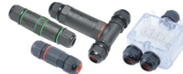
Представленные выше разъёмы имеют степень защиты IP68 и могут использоваться для прокладки кабеля в земле при условии залегания не глубже 10 м. Рассчитаны на работу в сети напряжением 450 В (50 Гц) с номинальным током от 10 до 24 А (в зависимости от модели). Жилы кабеля в разъёмах фиксируются винтовым способом.
