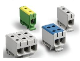
хода с алюминиевого на медный провод. Безопасное использование двух несовместимых видов проводов, обычно создающих при контакте эффект так называемой «гальванической коррозии», достигается благодаря применению при изготовлении контактных элементов блоков Ensto Clampo Pro, луженого алюминия (гасителем коррозии в данном случае является олово). Возможность контакта проводящих жил исключают также специальные разделительные перегородки из полиамида.
