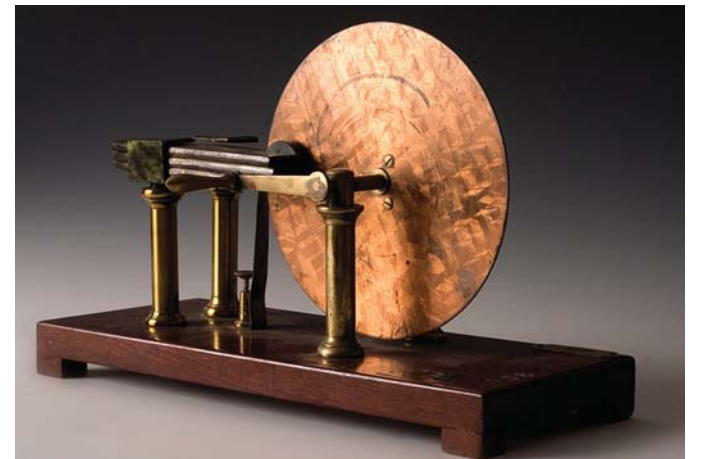
Диск Фарадея, 1831 год. Один из первых генераторов переменного тока
